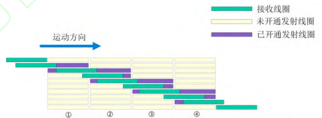
图 16 发射单元与接收线圈的相对位置及控制时序图
